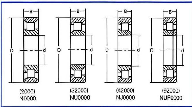
该类轴承主要用来承受径向载荷，与相同尺寸的深沟球轴承相比，有较大的径向承载能力，极限转速接近深沟球轴承。但与这类轴承配合的轴、壳体孔的加工精度要求较高，允许内外圈轴线相互倾斜度很小（ $2' \sim 4'$ ）。
